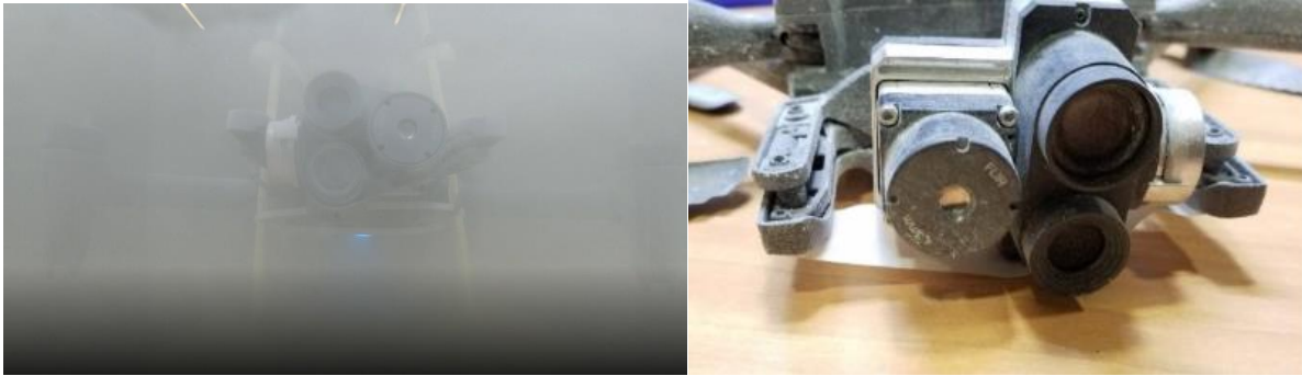
Fig. 7: IP5X test (sand)
